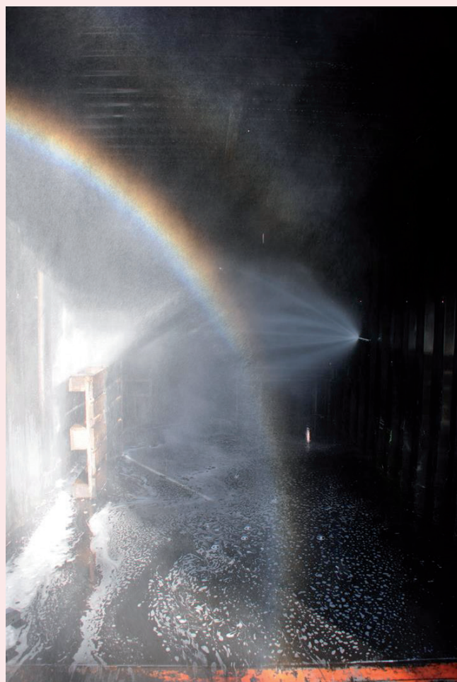
Feiner Wassernebel füllt den Container.
