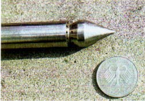
Bild 2: Die Spitze des Nagels „Restrictor“ mit den Austrittsdüsen. Die Münze soll als Anhaltspunkt für die Größe der Spitze dienen. Die Austrittsdüsen sind einander gegenüberliegend angeordnet, die austretenden Wasserstrahlen prallen im Zentrum zusammen und werden rechtwinklig abgelenkt. Gleichzeitig wird das Wasser weiter vernebelt
