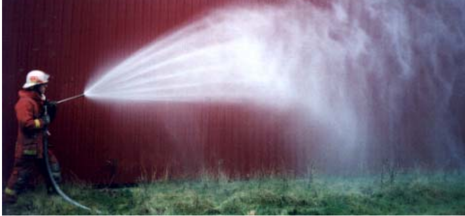
Bild 5: Der Strahl des Fog Nails „Attack“ ist stärker gebündelt. Die Tropfen sind größer
