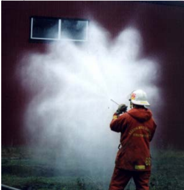
Bild 4: Das Sprühbild des Fog Nail „Restrictor“. Im Zentrum der Wasserstrahlen befindet sich die Spitze mit den Düsen
