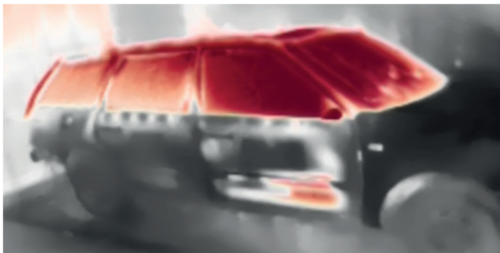
▲ Vollbrand im Fahrzeug-Innenraum. Die thermische Belastung des Bodenbereiches (Akku)
