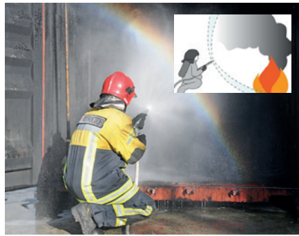
▲ Breitsprühnagel für den Mannschutz, das Schilden von Bränden und Einsatz in begrenzten Räumen.
