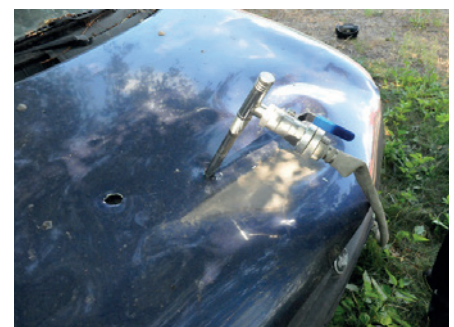
▲ Löschvorgang durch die Frontscheibe.
